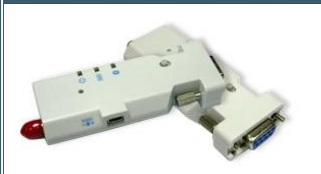
**М**алогабаритный последовательный Bluetooth - адаптер может быть подключен к любому прибору, имеющему стандартный 9-ти выводной разъем последовательного СОМ-порта. Это дает возможность обеспечить беспроводное соединение с другим последовательным Bluetooth - адаптером или другим устройством, поддерживающим Bluetooth, например, ноутбуком, PDA или мобильным телефоном, устранив при этом кабельные соединения.
