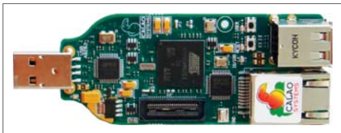
Рис.5. Микрокомпьютер Calao Systems USB-A9263
