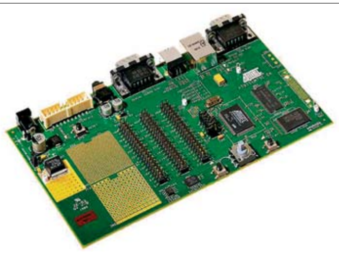
Рис.3. Отладочный комплект AT91SAM7SE-EK для микроконтроллеров семейства SAM7SE
