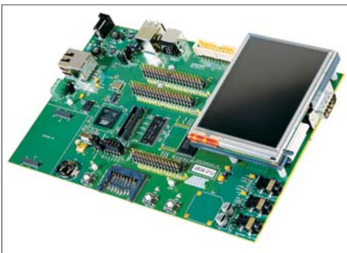
Рис.4. Отладочный комплект AT91SAM92-EK для микроконтроллеров AT91SAM9263
